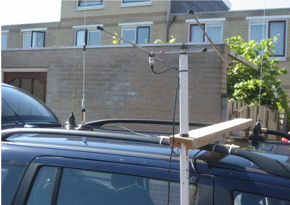
Afbeelding 2: HB9CV antenne op de auto voor de vossenjacht
